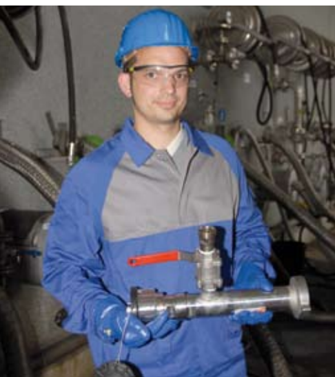
TKU mit Tankwagenanschluss und Probenehmer. Christopher Ernst, Meister Flüssigkeitsabfüllung
