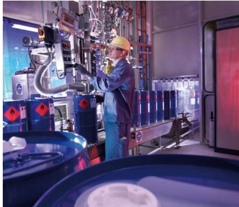
Abfüllanlage: Hier startet die Belieferung der Kunden in aller Welt mit Kleingebinden bis 50kg.
